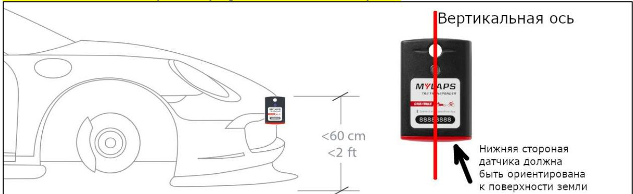
Рисунок 1. Схема монтажа датчика хронометража.
